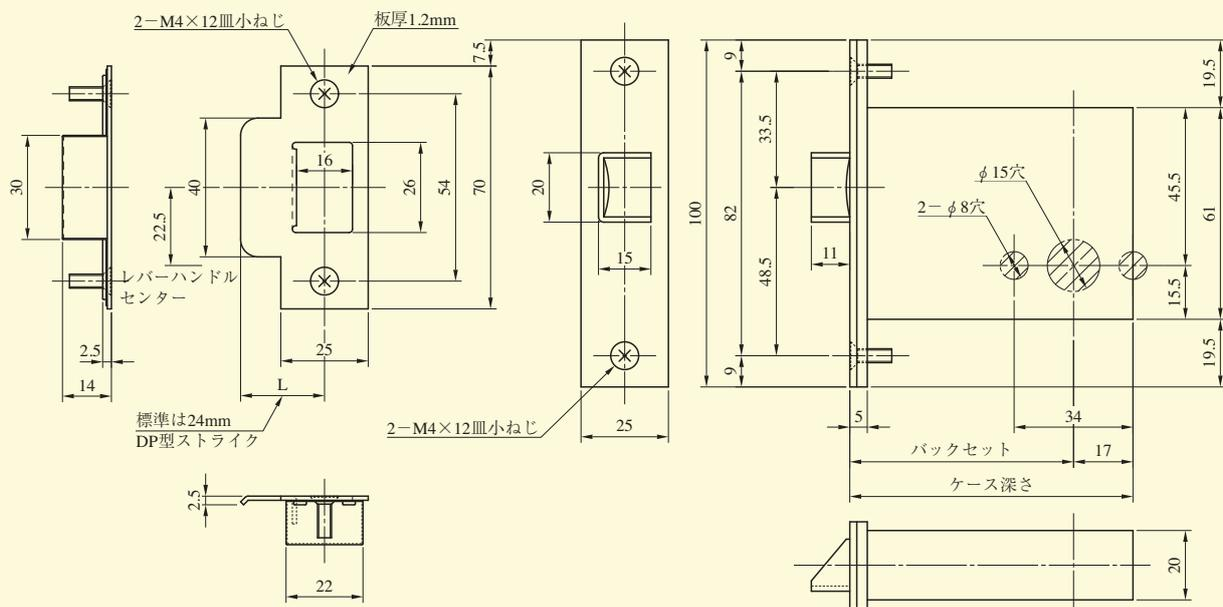
上図のストライクは木製枠、鋼製枠兼用のストライクです。ご購入時に鋼製枠のご指示がある場合のみ下図ストライクとなります。
